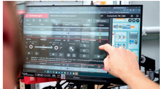
Das Assistenzsystem Eplan Smart Wiring visualisiert Montageaufbau, Betriebsmittel, Verbindungen und Verlegewege und führt durch den Verdrahtungsprozess.
