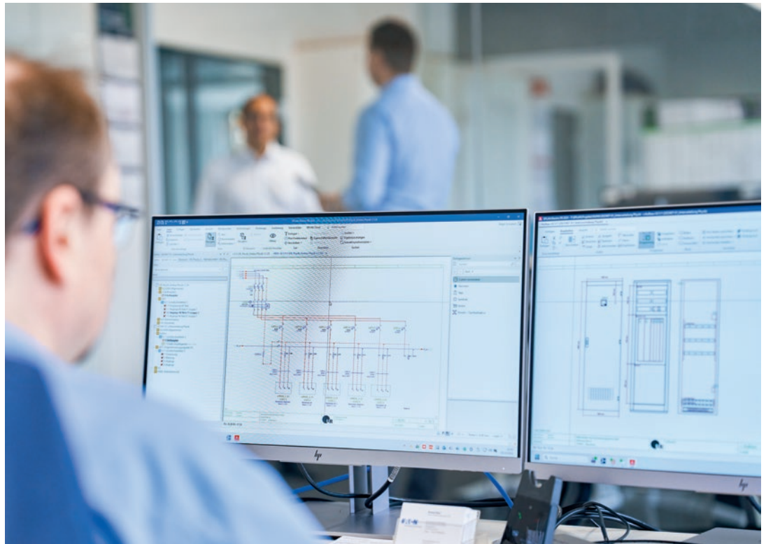
Ist der 3D-Schaltschrankaufbau in Eplan Pro Panel erfolgt, werden die Fertigungsdaten direkt in die Maschinen eingelesen.
