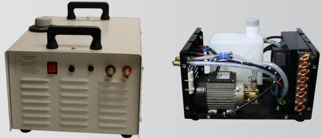
Funktion: Das Kühlgerät ist für einen geschlossenen Wasserkreislauf vorgesehen und basiert auf der Funktion einer Rückkühlanlage, d.h. die Kühlflüssigkeit wird durch einen Wärmetauscher auf annähernd Raumtemperatur zurückgekühlt. Der Wärmetauscher wird durch einen separaten Lüfter mit Raumluft gespeist.
