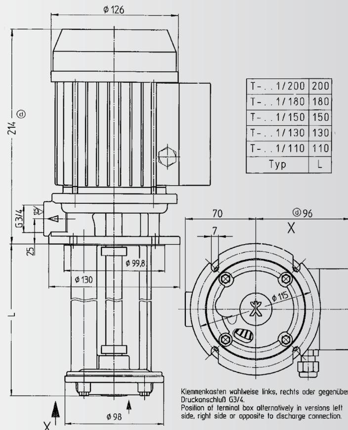
Tauchpumpe in weiteren Längen (110 / 130 / 150 / 180 / 200 mm) auf Anfrage erhältlich!
