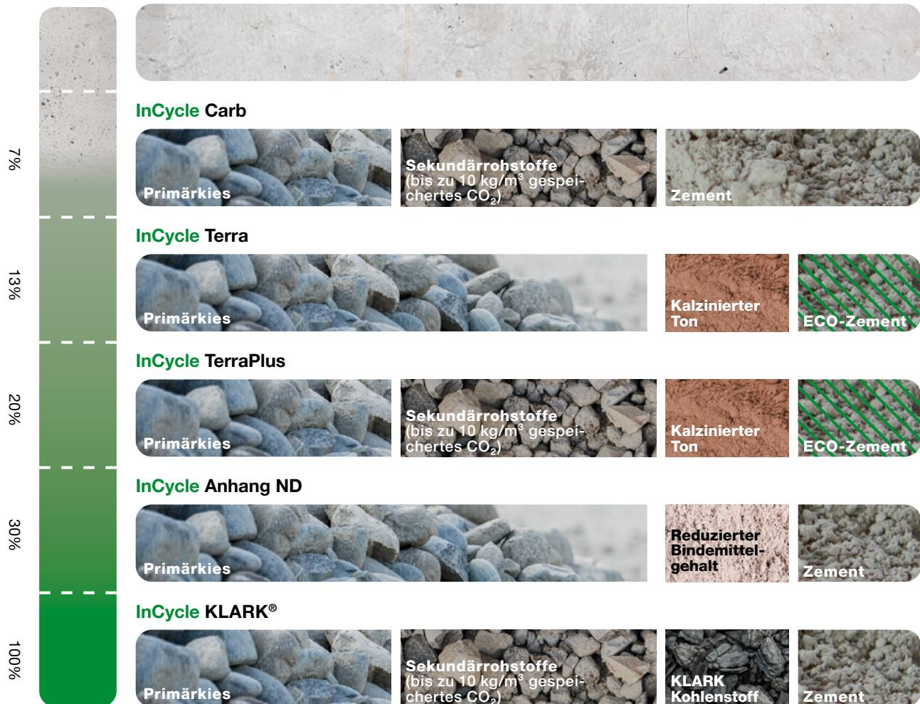
**Recycling-Konstruktionsbetonsorten - InCycle Carb (exkl. MwSt.)**
