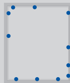
Systemdarstellung RC2 10 Verriegelungspunkte (auch erhältlich als WinTech Secure 2*)
