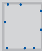
Systemdarstellung RC1 8 Verriegelungspunkte (auch erhältlich als WinTech Secure 1*)
