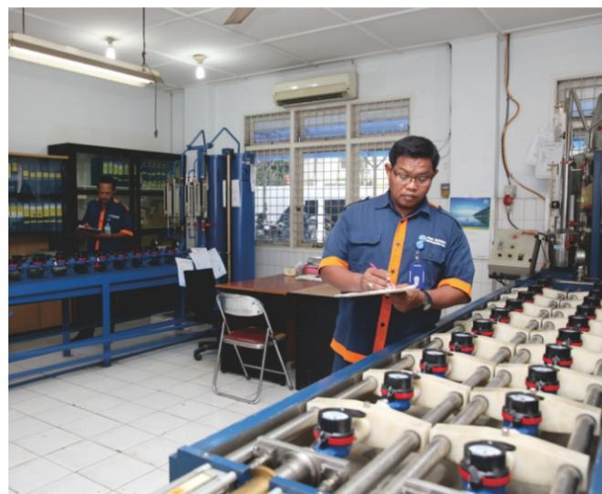
melalui suatu pipa yang dilengkapi dengan alat penunjuk untuk menyatakan volume. Misalnya : aliran air dalam pipa (transmisi maupun distribusi termasuk pipa dinas/rumah pelanggan). Meter air pelanggan difungsikan untuk mencatat dan mengontrol aliran yang masuk kesambungan rumah pelanggan. Meter air terbuat dari bahan yang tahan lama, tahan karat, tidak mudah aus, kuat dan tahan terhadap kerusakan akibat air. Meter air dirancang tahan suhu sampai
